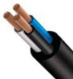
Condutor flexível de cobre nu, têmpera mole, encordoamento classe 5. Isolação de PVC/A 70°C - composto termoplástico extrudado à base de policloreto de vinila, com características especiais para não propagação e auto extinção do fogo.
